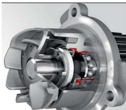
Применение высокотемпературного герметика исключает утечку охлаждающей жидкости через прессовое соединение уплотнения с корпусом.
